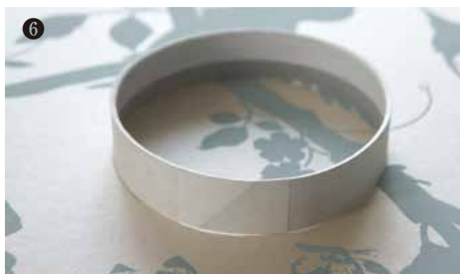
成形が完了した銅巻き（側面）
